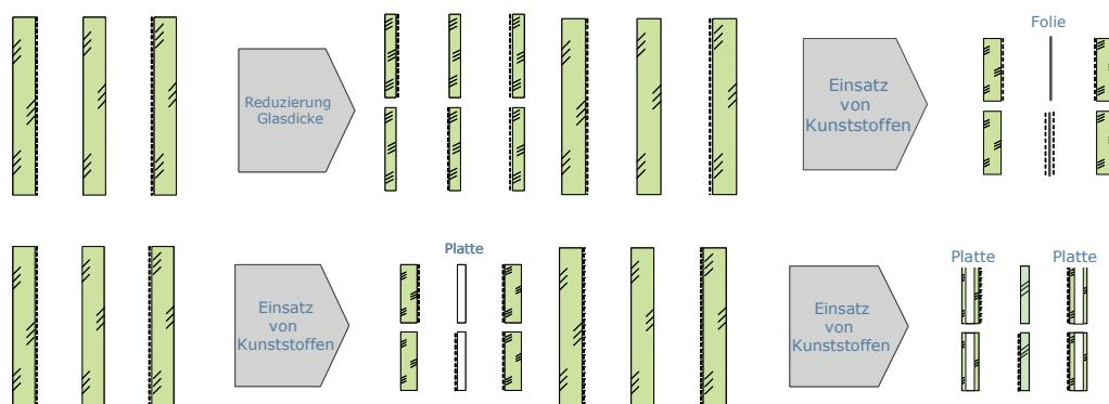
**Abbildung 1** Prinzipielle Möglichkeiten zur Reduzierung des Flächengewichtes
