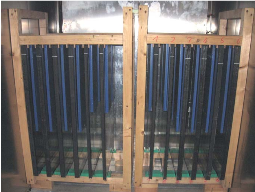
Abbildung 2 Lagerung der MIG in der Klimakammer mit Zusatzgewichten (blau) zur Simulation größerer Formate und Scheibenaufbauten
